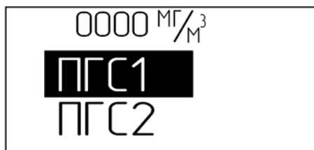
Рисунок 3.4 – Вид индикатора газоанализатора в режиме выбора ПГС, используемый для корректировки показаний.
