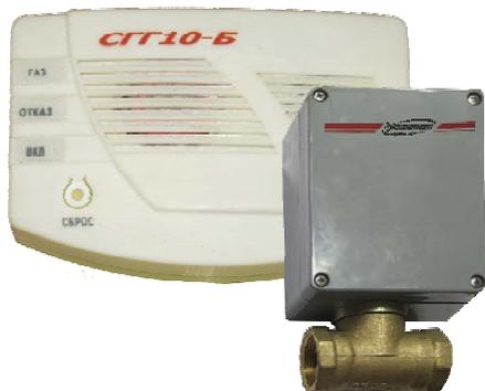
**Предназначены** для использования в системах дистанционного аварийного отключения потребителей в качестве запорного органа в трубопроводных системах для управления потоком топливных углеводородных газов (природного и сжиженного) с рабочим давлением до 0,005 МПа, в комплекте с СГГ10-Б. Клапан изготавливается для трубопроводов с условным проходом DN15, DN20, DN25, DN32.
